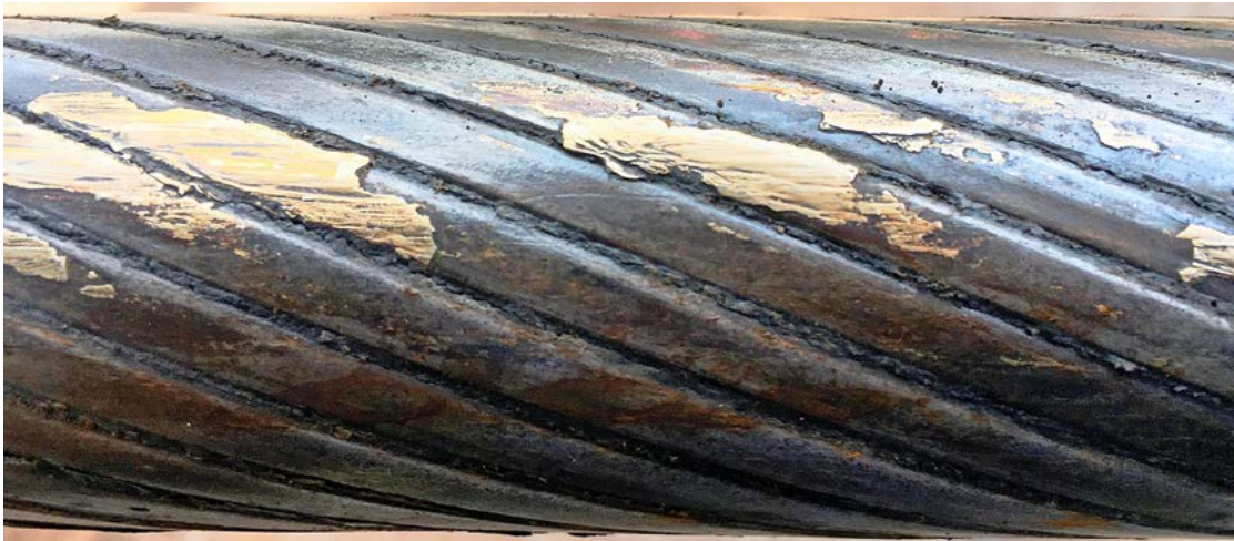
Bild 5: Bremspuren einer Fangbremsung, eine der möglichen Ursachen einer Schädigung wie in Bild 4 gezeigt.
