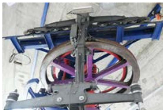
*Einzigartig ist die Umlenkung der Kabinen zusammen mit den Laufwerken um 180° in beiden Stationen.*
