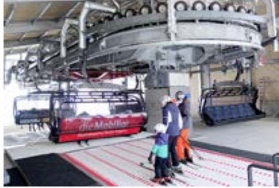
Mit dem Förderband und Hubtisch werden Kinder mühelos auf den Sessel gehoben.
