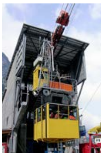
Die 5-Tonnen Windenbahn von Habegger, erbaut 1959 für den damaligen Kraftwerkbau in Lindt-Limmern, erwies sich bei Kraftwerkserweiterung in den Jahren von 2009 bis 2017 als zuverlässige Personen- und Transportbahn.
