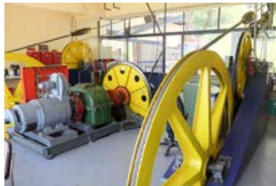
Le câble de traction et les câbles porteurs sont tendus dans la station inférieure.
