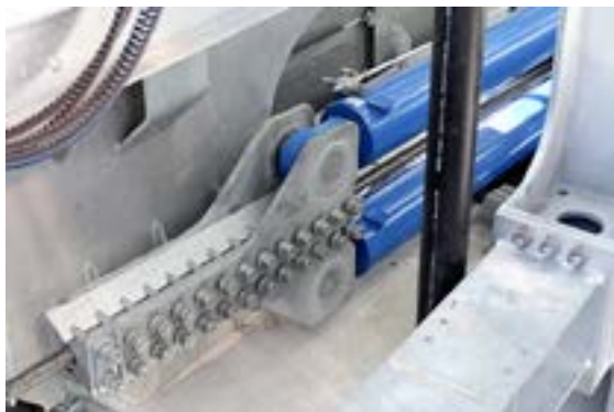
Les plaquettes de serrage hydrauliques incorporées pour pouvoir transférer rapidement les câbles porteurs constituent une particularité technique.
