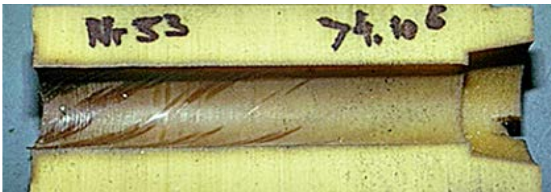
Abb. 6: Die in einem Stahlrohr eingelegte Schutzhülse aus Polyurethan (94° Sh A), aufgeschnitten nach dem Ermüdungsversuch.
