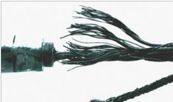
Abb. 1: Seilriss in der Nähe vom Austrittsquerschnitt, eine Folge der Ermüdungsbeanspruchung.
