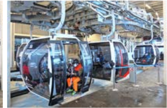
Die mechanischen Schranken in den Stationen reagieren sofort bei nicht verriegelten Türen der Kabinen.
