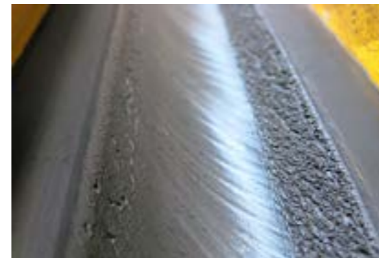
Bild 4: Einlageschnüre «sprechen» mit uns - hier läuft das Seil nicht zentrisch in eine Scheibe ein, sondern schräg.
