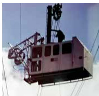
Weil man mit einem Bergfahrzeug die Hauptfahrzeuge nicht überfahren konnte, musste für die Dreiseilbahn in Saas-Fee eine komplette, kostspielige und unabhängige Berg-Windenbahn mit separater Fahrbahn über den beiden Fahrbahnen dazwischen erstellt werden.
