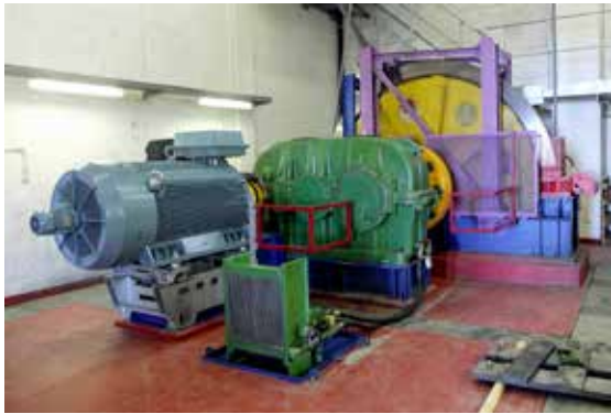
Der neue ABB-Motor für den Antrieb der zweiten Sektion, der sich in der Station Morenia befindet.
