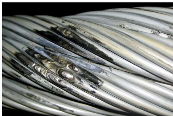
Beschädigung durch einen Blitzschlag.
