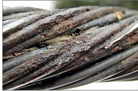
*Seilschaden infolge Korrosion.*
