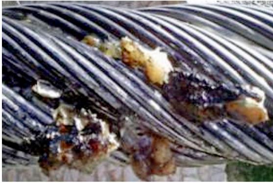
*Schaden durch Wärmeeinwirkung.*
