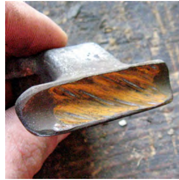
Abbildung 2: regelmässige Wartung der Klemmen ist sehr wichtig, nicht nur bei Seilwechsel.
