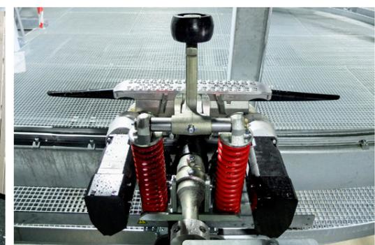
Zwei elektrische Motoren an der Klemme ermöglichen den Transport der Kabine in den Stationen.
