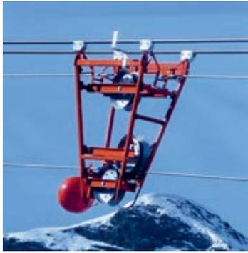
Die Seilreiter sind doppelstöckig gross und dienen gleichzeitig auch für die Flugwarnsignalisation sowie für die Rückführung des Zugseiles.
