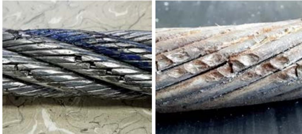
Bild 7: Ermüdungsbrüche an Verschleissellipsen eines Drahtseils, das über Stahlscheiben gelaufen ist.
