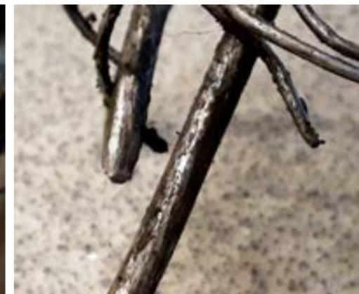
Bild 6: Teller-Tasse-Brüche an einem überlasteten Baumaschinenseil.
