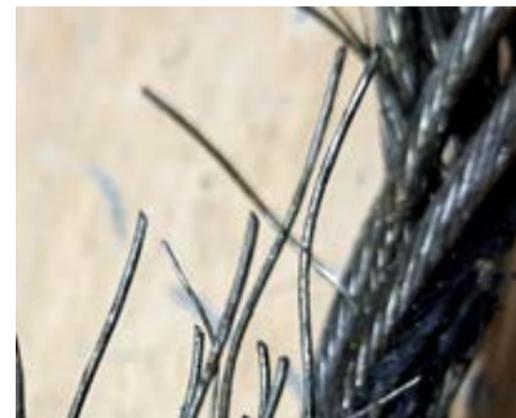
Bild 5: Scherbrüche an den Drähten eines gebrochenen Seils.
