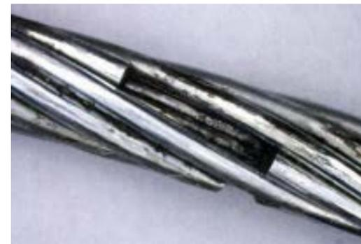
Bild 3: Ermüdungsbruch in einer Litze – die sehr klaren Bruchflächen verlaufen 90° zur Drahtachse.
