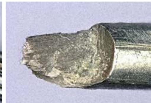
Bild 4: Vergrößerung eines Ermüdungsbruches, der Riss begann vorne im ebenen Bereich.
