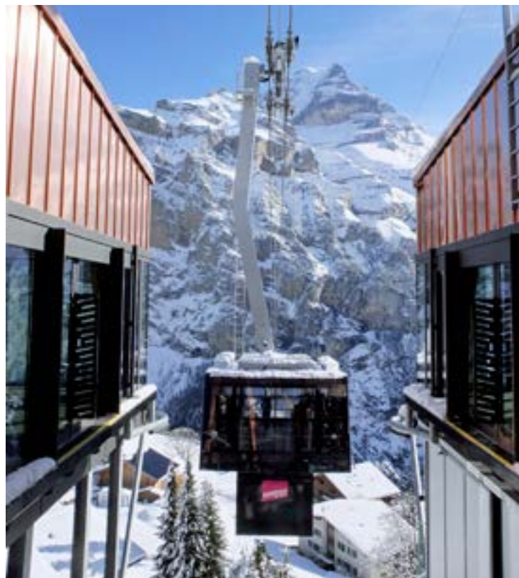
Dank eines 11 Meter langen Gehängearms kann die Steigung von 159 Prozent überwunden werden.
