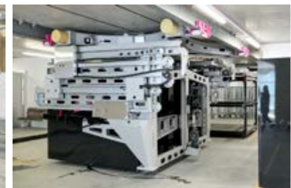
Ein Verloaderoboter führt die Unterlast in die Station von Mürren.
