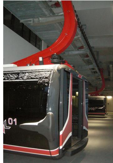
Mit dem Vertikalförderer für die Garagierung der Kabinen einen Stock tiefer sorgte Doppelmayr bereits in Sochi für Aufsehen, eine effiziente Methode, die ihre Anwendung auch in Ischgl fand.
