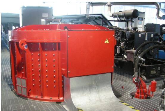
Leitner verwendete erstmals für den Antrieb von 3S-Seilbahnen das System des Direktantriebes.
