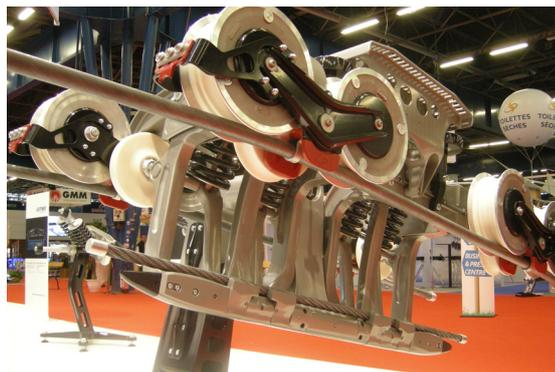
*Ein gebauter Fahrzeugdetektor am Laufwerk, zeigt mögliche Rollendefekte direkt an.*
