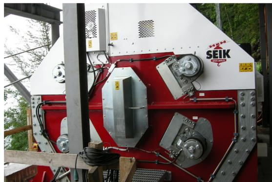
Die Elektrowinde mit einer Leistung von 720kW wurde vom Materialeillieferant Seik aus Südtirol geliefert.
