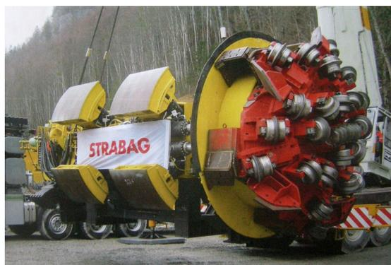
Mit der Tunnelbohrmaschine erfolgt der Ausbruch des 1.9 km langen Parallel-Druckschachts zwischen dem Kraftwerk Innerkirchen 1 und dem Wasserschloss Kapf.
