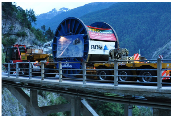
Je nach Traglast der Brücke muss das Seil mittels Hilfsbobine von einer Bobine auf die andere Bobine umgespult werden.
