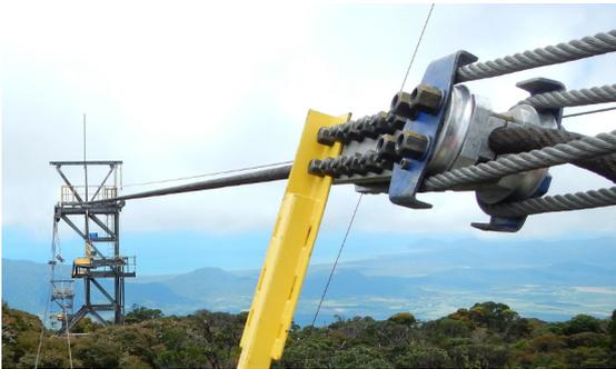
Anlage in Avoriaz konnte ebenfalls von diesen Klemmen profitieren und selbst in Australien, mitten im Dschungel werden Seilbahnseile mittels dieser leichten Klemmen gewechselt.
