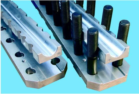
*Schonende und geringe Flächenpressung auf das Seil, das Seil wird beim Festklemmen im runden Seilbett nicht verformt. Auswechselbare Seilbettschienen mit verschiedenen Seildurchmessern pro Klemmplatzentyp.*
