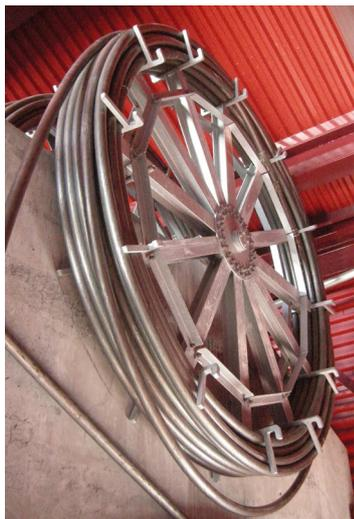
*An den Haspeln in der Bergstation sind rund 40 Meter Seil aufgerollt, damit vier Tragseilverschiebungen durchgeführt werden können.*
