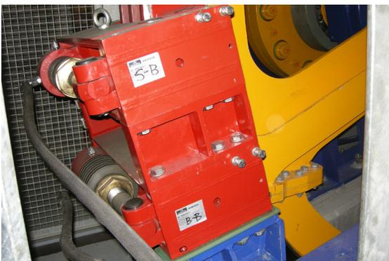
*Die Betriebs- und die Sicherheitsbremse sind am Antriebsrad aufeinander zusammengesetzt.*
