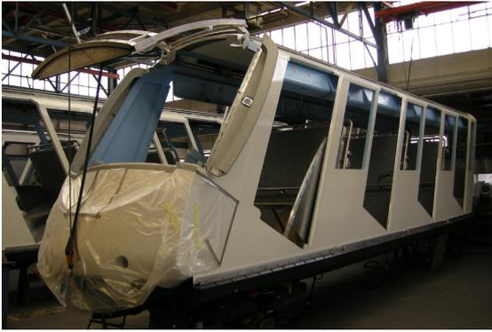
*Eine Spezialität der neuen Züge sind die Frontklappen auf der Talseite. Sie dienen zum Beladen der Lasten für die Bergrestaurants. Das Bild entstand während der Konstruktionsphase der Fahrzeuge im Firmagelände der Gangloff Cabins AG in Bern.*
