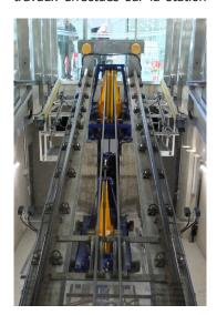
Des vérins hydrauliques (entraînement de composition) dans la station d'altitude garantissent que les véhicules s'arretent toujours dans la position adéquate des stations interméditaires.
