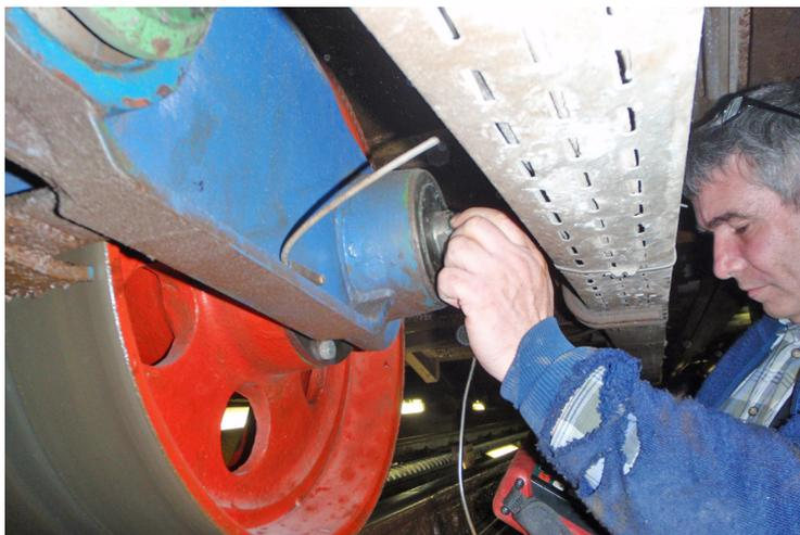
Contrôle par ultrason d'un funiculaire.
