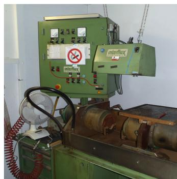
*A l'aide du banc d'aimantation, les plus fines fissures peuvent être détectées.*
