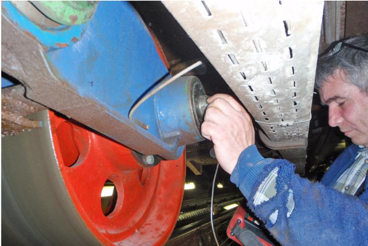
Durchführung einer Ultraschallprüfung an einer Standseilbahn.
