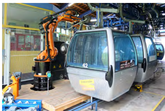
Roboter in den Stationen Bort und Schreckfeld be- und entladen die Gondeln automatisch mit den Mountaintarts.
