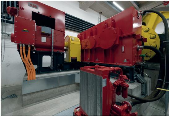
Zwei Nieder Spannungsmotoren von ABB bewerkstelligen den Hauptantrieb mit je 1,15 Megawatt.
