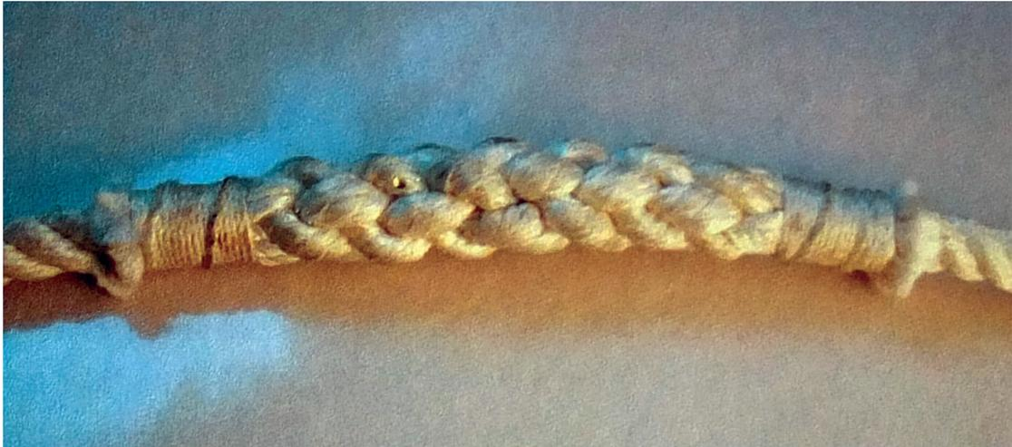
Kurzpleiss mit Endsicherung.
