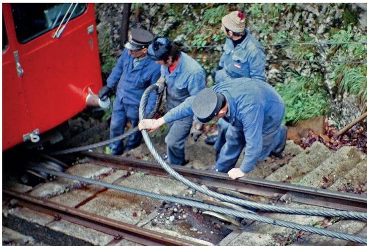
*Abb. 1: Die Schleife muss in Handarbeit aufgelöst werden, damit sich bei neuer Belastung keine «Klanke» bildet und das Seil zerstört wird.*
