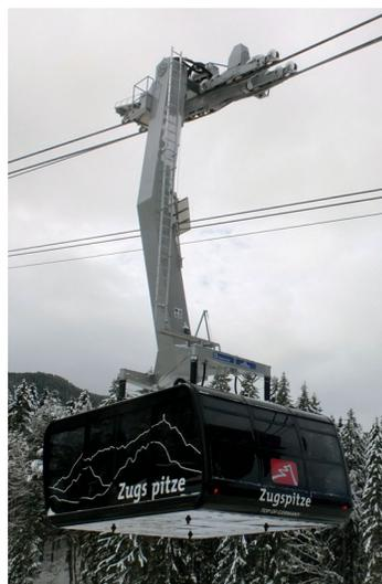
*Une nouvelle cabine de style du type Kronos P de CWA a vu le jour grâce à la collaboration constructive du client.*
