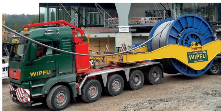
Le transport et le tirage des quatre câbles porteurs, d'un poids de respectivement 153 tonnes, a constitué une performance en matière de planification et de réalisation.
