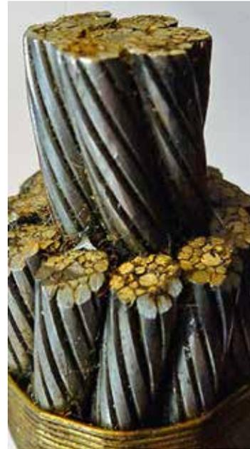
Abb. 5: Bei sog. drehungsarmen (Litzenspiral) Seilen sind die geometrischen Daten so gewählt, dass sich die aus der Zugkraft stammenden Drehmomente der einzelnen Litzenlagen aufheben.
