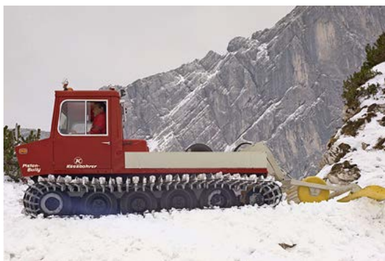
Bereits der erste PistenBully auf der Seiser Alm war mit einem hydrostatischen Antrieb ausgestattet.
