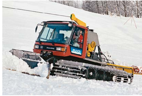
1984 entwickelte Kässbohrer auf Basis des PistenBullys 200 D ein Windenfahrzeug mit Treibtrommelsystem.
