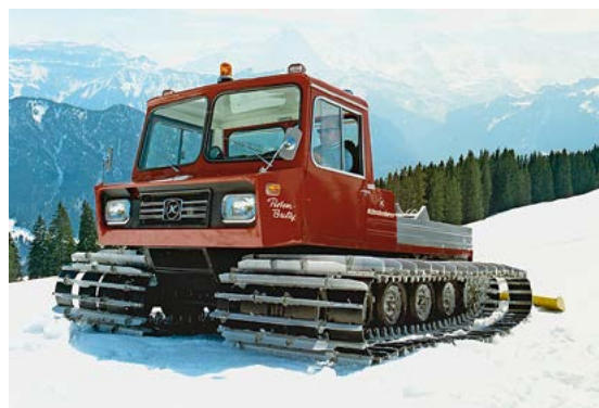
Der erste PistenBully mit Dieselmotor wurde ab 1971 gebaut und erwies sich in Verbindung mit dem hydrostatischen Antrieb als unschlagbar.
