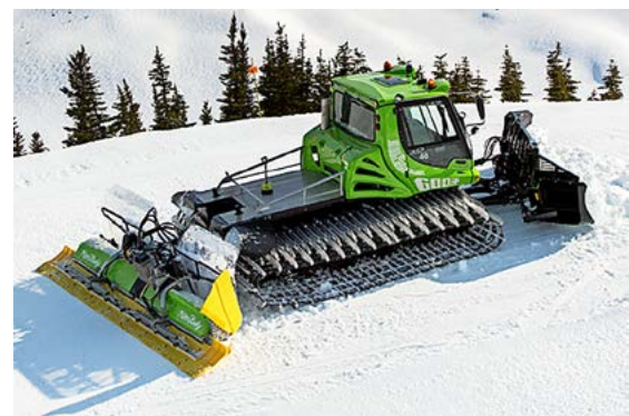
PistenBully 600 E+: Schon 1998 lief bereits ein PistenBully-Prototyp mit Hybridantrieb. 2012 wurde auf Basis des PistenBullys 600 die Serienreife erreicht.
