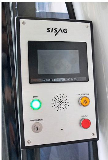
Die Kommunikation von der Kabine zur Leitzentrale wird über eine Sprechanlage sichergestellt.
