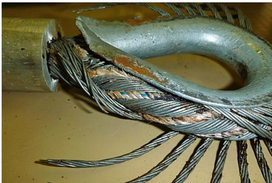
Die in Abb. 2 dargestellte Kausche von links gesehen. Man beachte die rostbraune Scheuerspur an der Flanke, entstanden von der Einspannung und die aufgebogene Spitze der Kausche. Dies zeigt, wie stark die Biegung des Seiles war.
