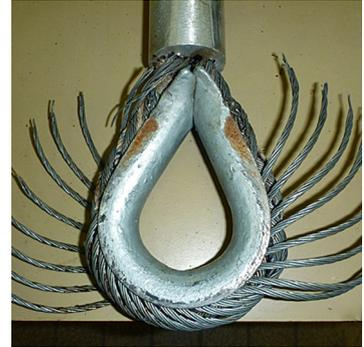
Abb. 2: Diese Kausche war seitlich eingespannt und das Seil quer zur Richtung des Bolzens wiederholt gebogen worden. Die Biegung konzentrierte sich deshalb zwischen der Kausche und der Pressklemme, wo sich die Drähte gegenseitig nicht verschieben können. Infolge der Wechselbiegung brachen an dieser Stelle die Drähte und 8 der 9 Aussenlitzen.
