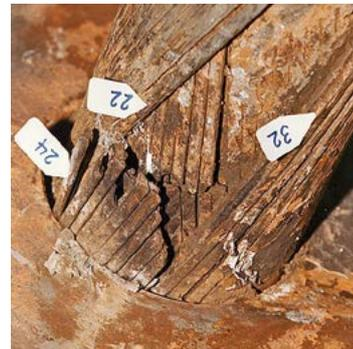
*Bild 5: Nach dem Entfernen der Ummantelung von Bild 4 wurden die fortgeschrittene Korrosion und eine Anzahl Drahtbrüche sichtbar. Ohne Ummantelung wäre die Korrosion möglicherweise gar nicht eingetreten bzw. schon viel früher entdeckt worden. (Foto: EMPA)*
