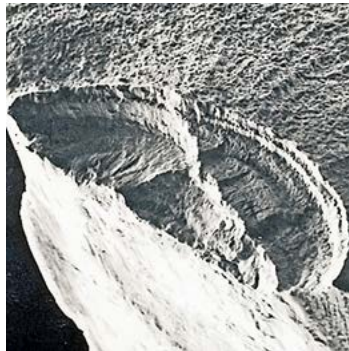
Abb. 7, [6]: Der Ermüdungsbruch begann an der Druckstelle vom Nachbardraht (B).
