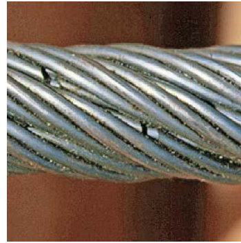
Abb. 8. Innere Drahtbrüche (B) infolge gegenseitigem Druck der Litzen. Die Einlage des Seiles war zu dünn bemessen.
