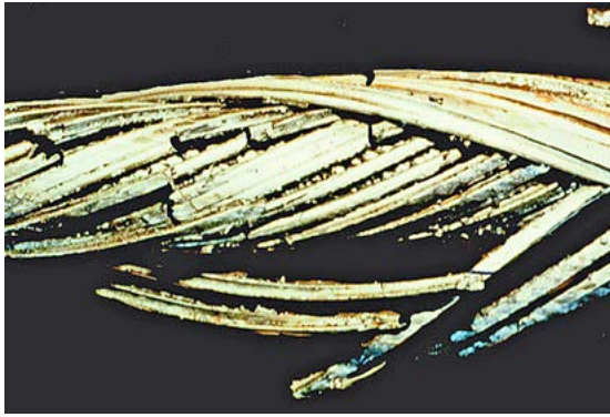
Abb. 10: Nach der Entfernung der äusseren Profildrahtlage sichtbar gewordene innere Drahtbrüche (B) in der zweiten Drahtlage eines verschlossenen Seiles, mitverursacht durch den Auflagedruck der äusseren Profildrähte.
