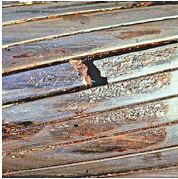
Abb. 4: Bruch eines Profildrahtes durch hohe örtliche Querpressung (A) bei der Auflage des Seiles auf einer Rollenketten.
