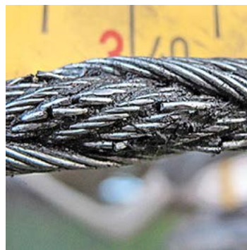
Abb. 9, [6]: Innere Drahtbrüche (B) bei einem mehrlagigen Litzenseil, verursacht durch die Querpressung der äusseren Litzen auf die innere Lage. Äussere Litzen wurden entfernt, um die inneren Litzen sichtbar zu machen.
