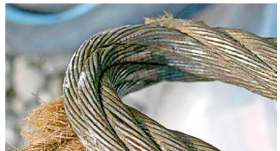
Abb. 5: Bei dieser Umlenkung wurde die Einlage des Seiles herausgedrückt, was eine weitere Reduktion der Bruchkraft ergibt.
