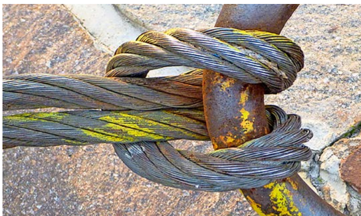
Abb. 1: Bei dieser Verankerung muss mit der Reduktion der Bruchkraft etwa auf die Hälfte gerechnet werden.
