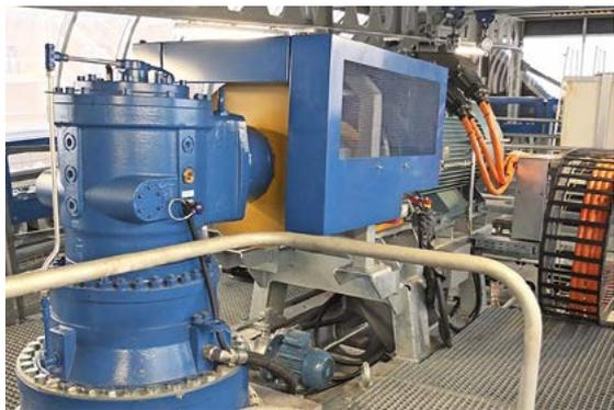
*L'entraînement est doté d'un moteur ABB, de même que d'un réducteur de Brevini et offre une puissance de 418 kW.*
