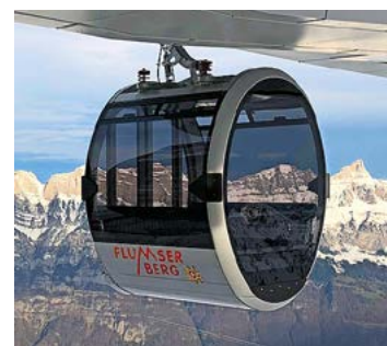
Die Gondeln zeichnen sich durch Sicherheits-Verbund-Gläser und ein grosszügiges Interieur-Design aus.
